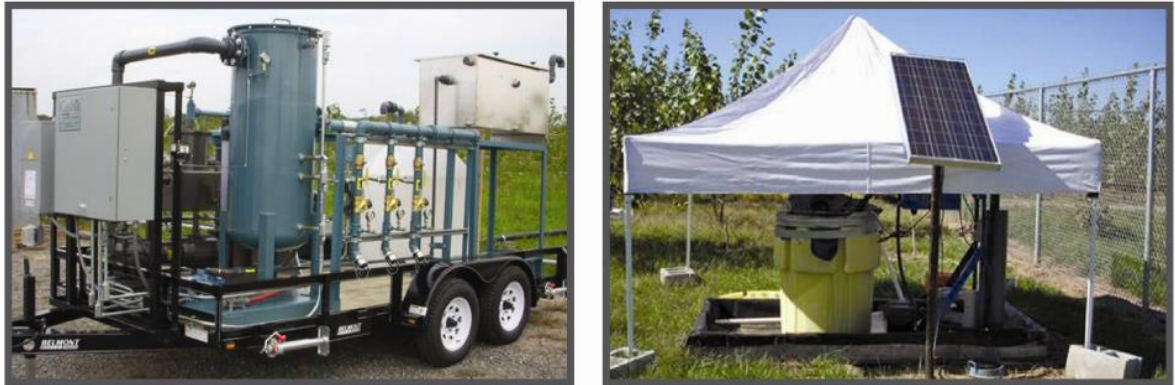
Figura 8 - Exemplos de sistemas de remediação: unidade de extração multifásica (à esquerda) e skimmer movido à energia solar em site no leste dos EUA
